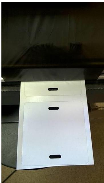
7. При печати бирок нужно создать в программе этикетку, высота которой равна расстоянию между нижними просечками двух последовательных бирок. В данном случае в программе cablabel S3 Lite мы создаём этикетку с высотой 57 мм (для комплекта PUE10) и шириной 55 мм. Подробнее о создании этикеток см. в инструкции по программе cablabel S3.
