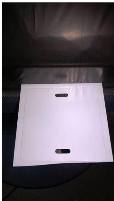
6. В таком случае нужно нажать кнопку протяжки ещё раз. Теперь над зубцами находится нижняя просечка следующей бирки:
